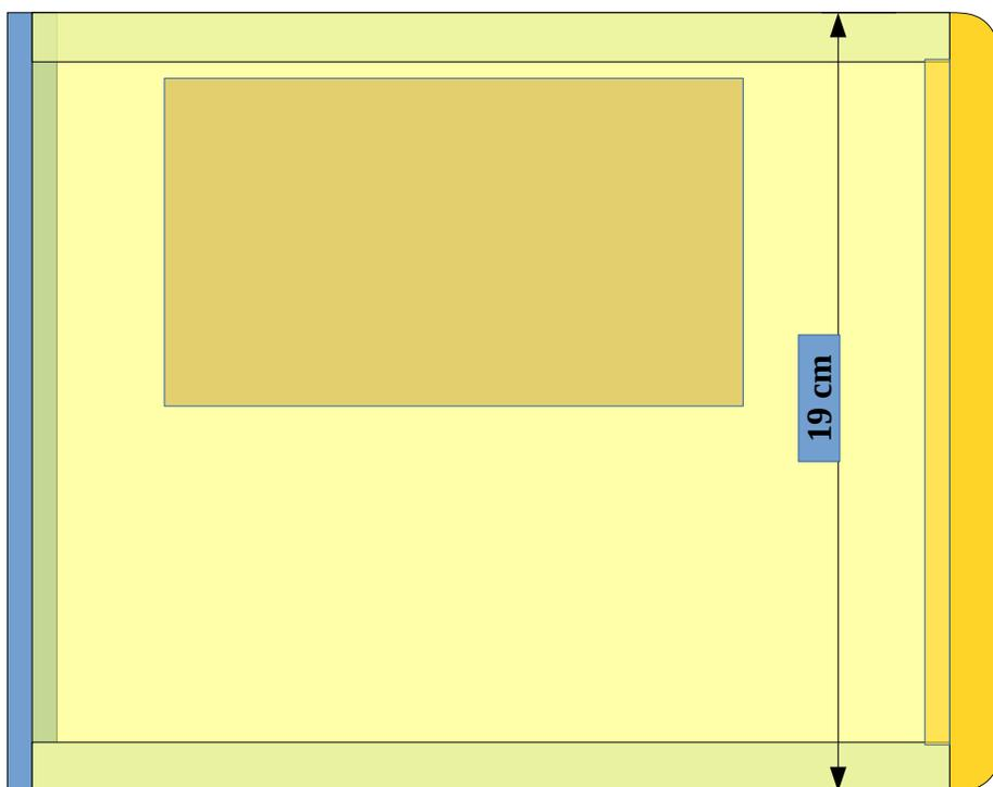
**Fronten auf Rückseite umlaufend 6x12mm Fasen, nach zusammenleimen mit Seiten- und Ober-/Unterteilen auf Vorderseite von vorn und die Kanten nach hinten 12mm Rundfasen umlaufend, Ecken per Hand rundschleifen, Vorbohrlöcher für Driver und Resonator setzen, und anschliessend LACK!!!**
